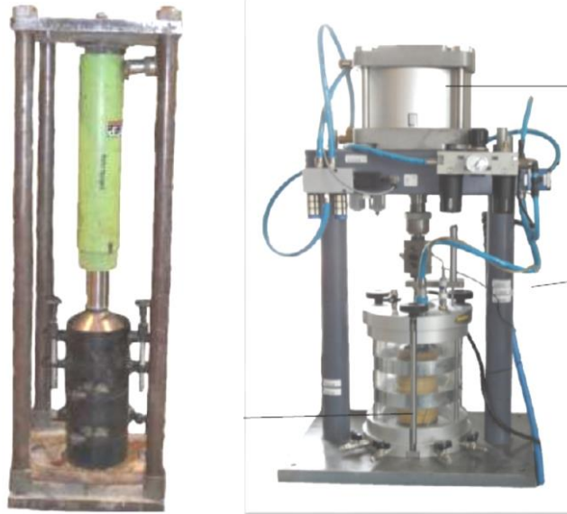
Obrázek 6.: Hutnění zkušebních těles a cyklické triaxiální zkoušení upravených zemin, experimentálně podle ČSN EN 13286-7
