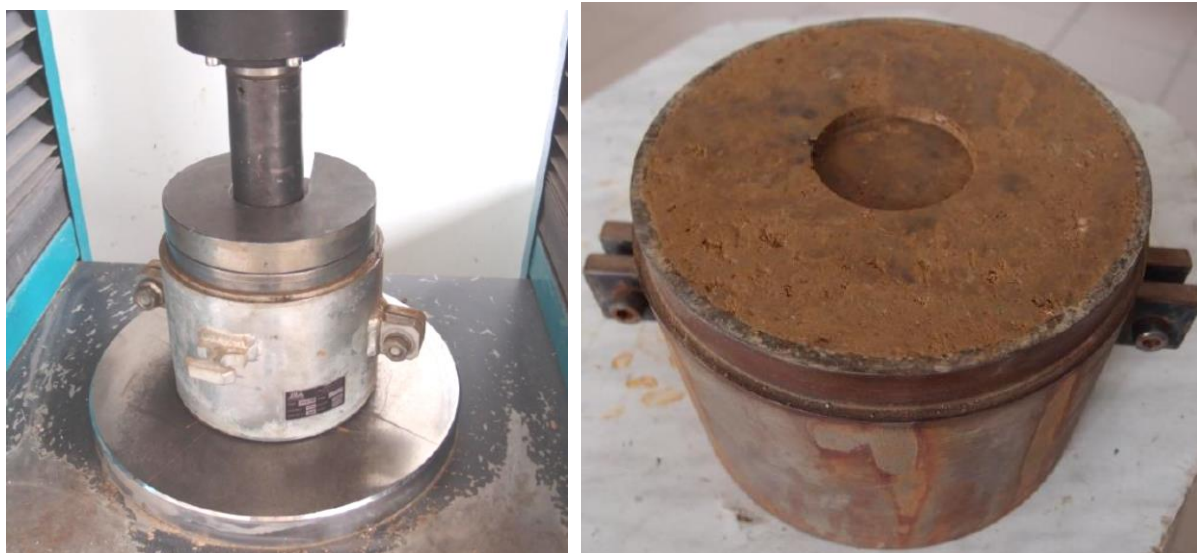
Obrázek 3.: Zkušební vzorky F6 C1 při a po zkoušce CBR
