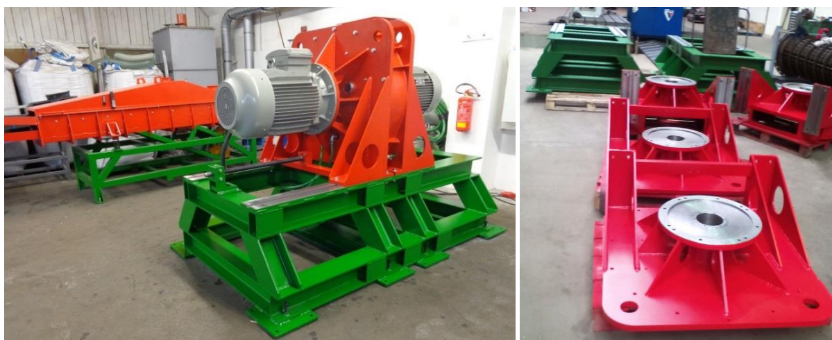
Obrázek 2: Vysokorychlostní mlýn (vlevo rozevřené mezikruží rotorů pro osazení mlecích elementů)
